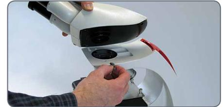
3. Ziehen Sie die unverlierbare Flügelschraube mit dem im Lieferumfang enthaltenen Schraubenschlüssel an.
