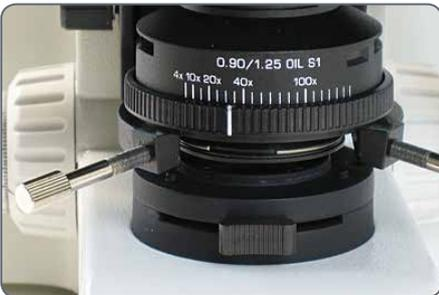
5. Bringen Sie den Kondensor mithilfe des Kondensorfokussierknopfes links an der Tischaufnahme in die höchste Stellung.
