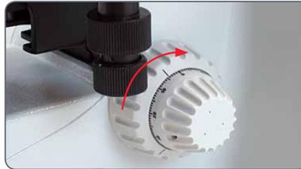
2. Bringen Sie die Kondensorhalterung mithilfe des Kondensorfokussierknopfes links an der Tischaufnahme in die tiefste Stellung.
