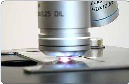
6. Halten Sie den Rändelring am Objektivrevolver und schwingen Sie das Objektiv hin und her, um Luftblasen zu beseitigen. Bringen Sie dann das Ölobjektiv in die endgültige Position, sodass sich der Öltropfen zwischen der vorderen Linse des Objektivs und dem Objektträger befindet.
