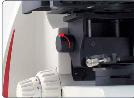
6. Ziehen Sie die beiden Stellschrauben mit dem im Lieferumfang enthaltenen Werkzeug an (bzw. ziehen Sie bei einem Köhlerstativ die beiden Flügelschrauben an), sodass die obere Linse des Kondensors in der Arbeitsposition unter dem Objektiv zentriert ist und der Objekttisch-Kondensor somit grob zentriert ist.
