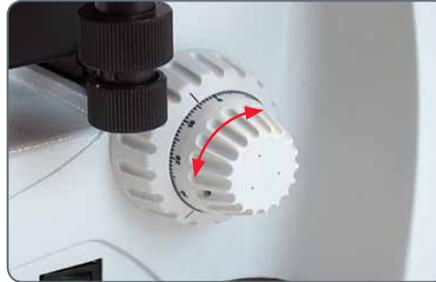
3. Schauen Sie jetzt mit dem anderen Auge nur durch das andere Okular (Fokussierokular). Fokussieren Sie jetzt das Präparat mithilfe der Fokussierfunktion des Okulars.
