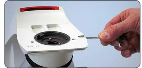
2. Setzen Sie den Schwalbenschwanz in die Stativhalterung ein und ziehen Sie den Gewindestift an (ohne zu viel Kraft anzuwenden). Dadurch wird der Tubus – unabhängig von der gewählten Rotation – präzise auf der optischen Achse des Mikroskops platziert.
