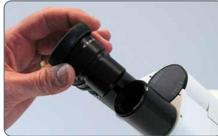
2. Sichern Sie die Okulare in den Tuben durch Anziehen der silbernen Schrauben an der Unterseite der Tuben mit einem Standard-Kreuzschlitzschraubendreher (nicht im Lieferumfang enthalten).
