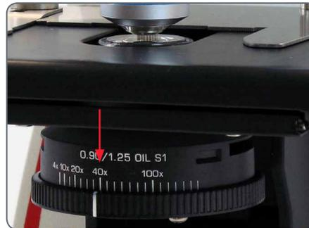
*Die Linie am Ring wird mit der verwendeten Objektivvergrößerung ausgerichtet.*
