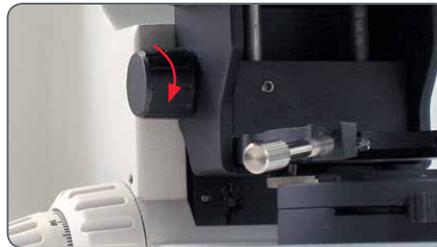
3. Lösen Sie die beiden Stellschrauben (bzw. Flügelschrauben bei einem Köhler-Stativ) an der Kondensorhalterung.
