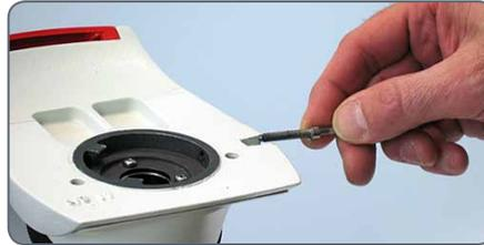
**⚠** Achten Sie darauf, dass der Flügelschraubenanteil der unverlierbaren Flügelschraube vollständig gelöst ist, bevor Sie sie am Stativ verwenden:
